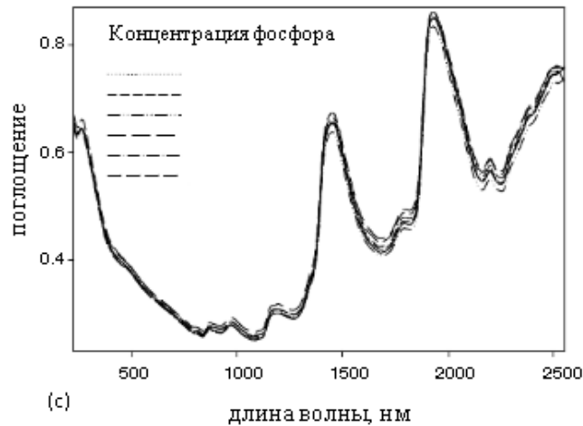
Рисунок 1 – Спектры поглощения почвы при разных содержаниях фосфора при влажности 4% (а); 8% (б); 12% (с)
