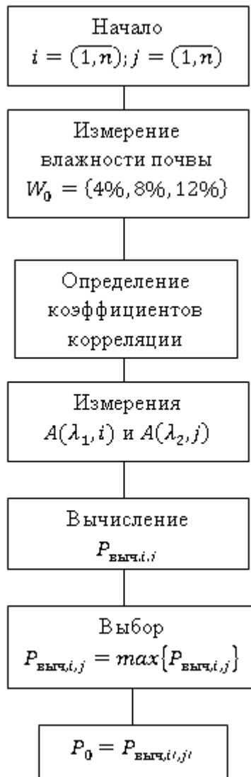
Рисунок 4 – Блок-схема алгоритма реализации двухволнового метода
